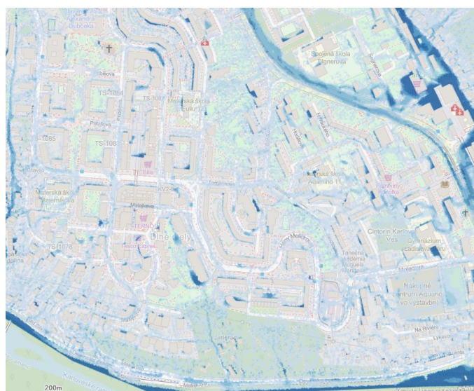
Obr. 9: Zrážkovo-odtokový model – detail Dlhé diely v MČ Karlova Ves (zdroj: DHI), čím tmavšia modrá farba na mape, tým väčšia je hĺbka odtekajúcej vody (pri silnom daždi) na danom mieste.
